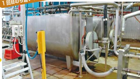
タンクから移されたハチミツはポンプを通り、フィルターでろ過される。
